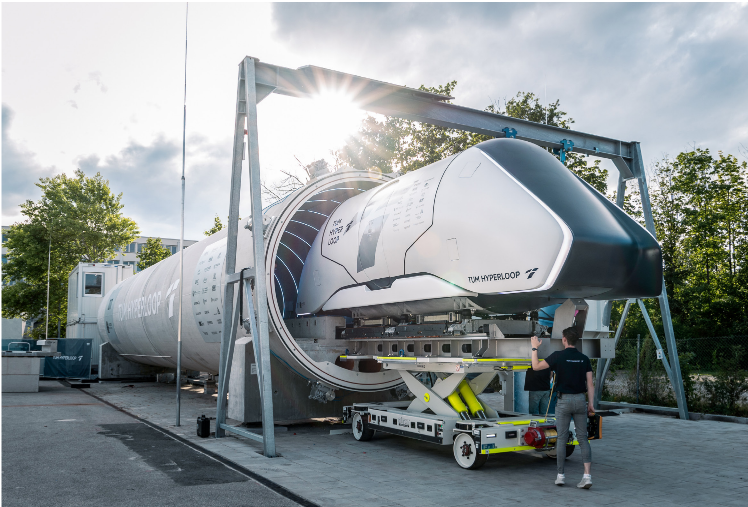
Einführung des TUM Hyperloop Pods in die Vakuumröhre zur Vorbereitung des Passagiertests
